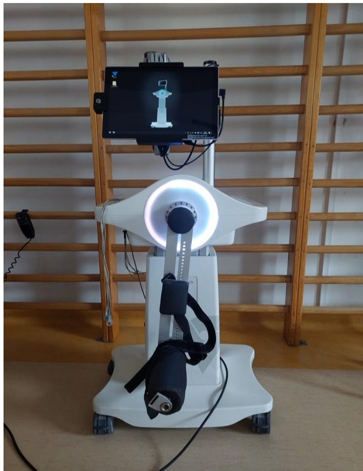
Rycina 2. Robot Luna EMG [źródło: materiały własne]
